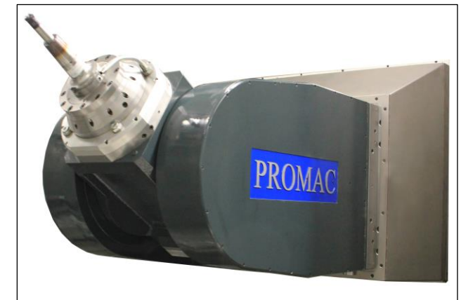
Testa a forcella con motori torque
